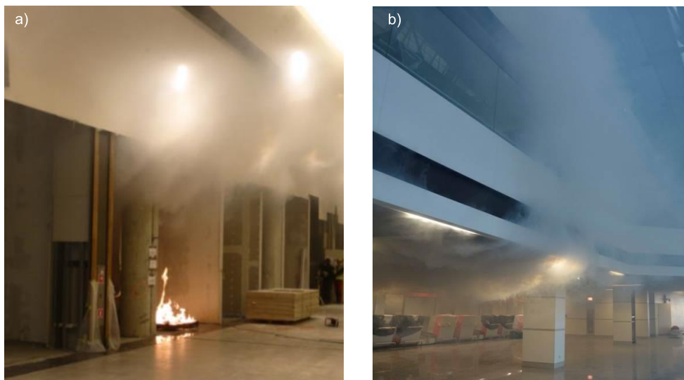
Fot. 2. Dym rozprzestrzeniający się w budynku wielokubaturowym a) wypływ dymu z lokalu do pasażu, b) dym opływający poziomą przegrodę budowlaną (fot. Autora)
