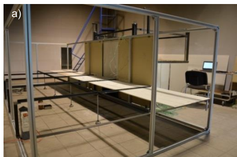
Fot. 5. Widok przegrody poziomej stanowiącej model pasażu handlowego a) widok z góry, b) widok z dołu (fot. Autora. Laboratorium ITB w Warszawie)
