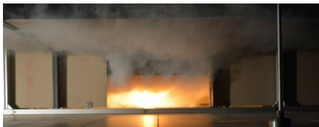
Fot. 9. Widok dymu płynącego pod przegrodą poziomą – badania fizykalne (fot. Autora)
